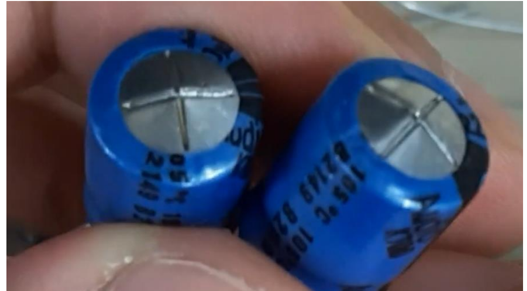
防爆弁が作動した様子 ふくらんで裂けている
